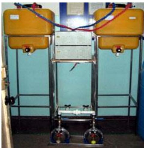
Промышленные электролизные комплексы (на базе электролизёров «САНЕР-5-400-01») предназначены для обеззараживания сточных вод, обработки воды в бассейнах, на станциях водоподготовки. Комплексы могут применяться для обработки технологического оборудования в пищевой промышленности, сельском хозяйстве, животноводческих комплексах; для обработке водопроводов.
